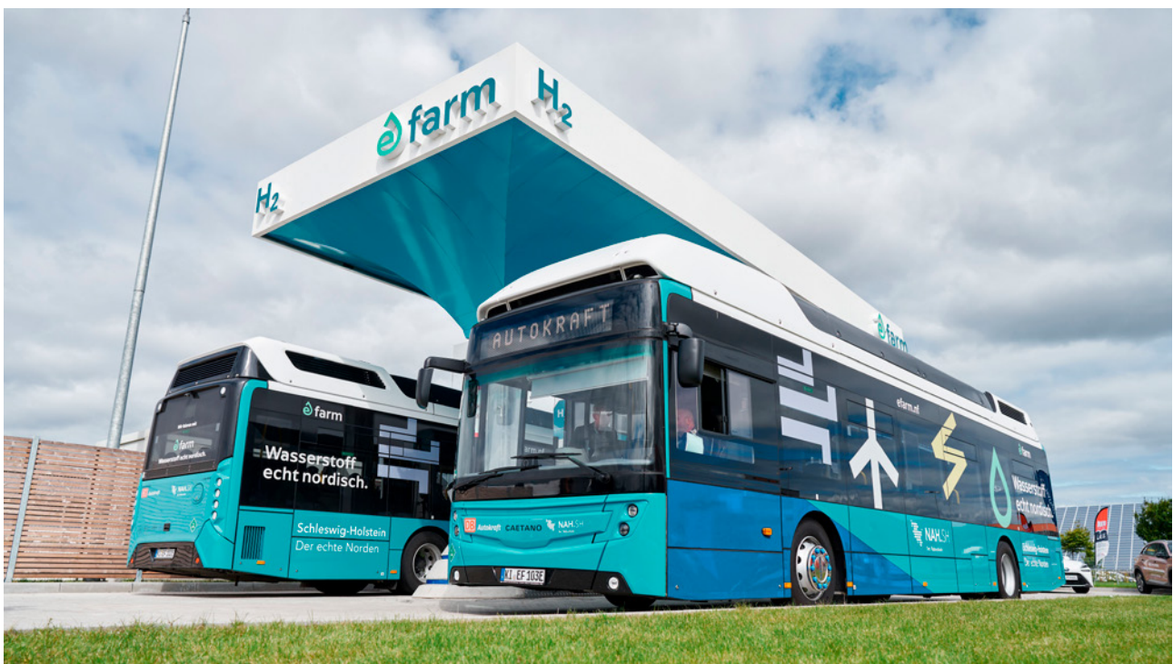
CO 2 -frei unterwegs: Die Brennstoffzellenbusse tanken in Niebüll grünen Wasserstoff.
