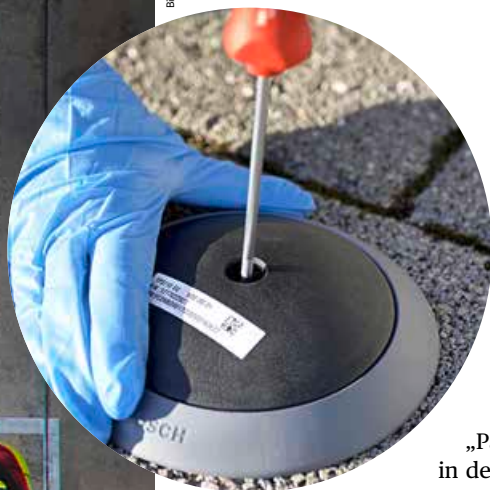
Der Bodensensor von Bosch ermittelt den Belegungszustand eines Parkplatzes und übermittelt die Information per LoRAWAN
