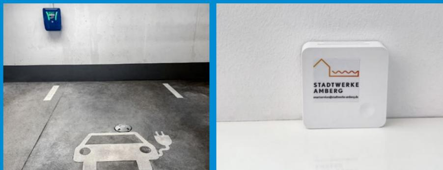
Zwei unterschiedliche Anwendungen: Sensoren zeigen freie Parkplätze an Ladeinfrastrukturen und kontrollieren die Auslastung. Raumsensoren erfassen die Temperatur und Luftqualität für ein besseres Raumklima.
