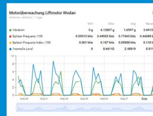
Predictive Maintenance: Überwachung von Liftmotoren
