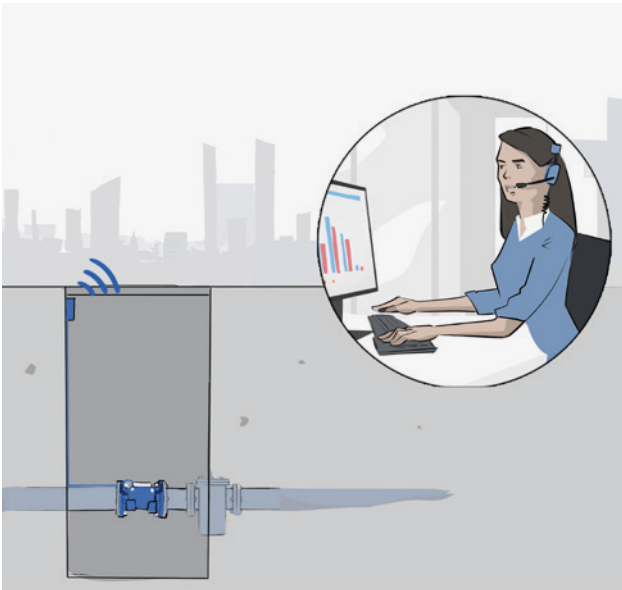
LoRaWAN® macht manuelle Schachtzählerauslesungen überflüssig.
